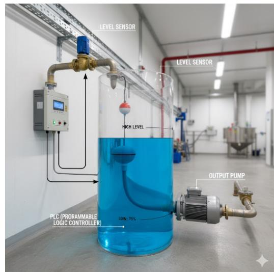
Um sensor de nível envia sinal a um CLP, que comanda uma válvula solenóide de entrada e uma bomba de saída. Quando o nível atinge o valor alto, deseja-se esvaziar o tanque; quando atinge o valor baixo, deseja-se encher. Dentro desse contexto, qual das concepções/especificações **NÃO** se justifica?
