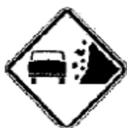
A-27 Área com desmoronamento
