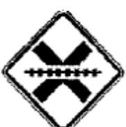
A-39 Passagem de nível com barreira
