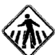
A-32b Passagem sinalizada de pedestres
