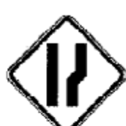
A-21e Alargamento de pista à direita
